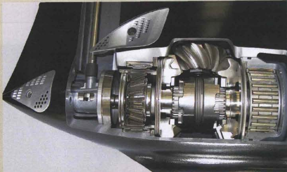
Sul nuovo DF300 (sigla AP) Suzuki ha unificato i cuscinetti posti all'interno del piede così che sia l'ingranaggio della marcia avanti sia quello della retro possono essere gravati degli stessi target di potenza.
